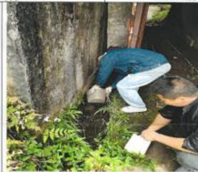
地下水现场采样
