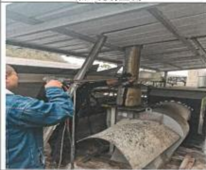
有组织废气现场采样
