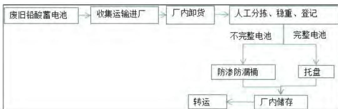
图 3.3-12 废铅蓄电池回收工艺流程及产污环节图
