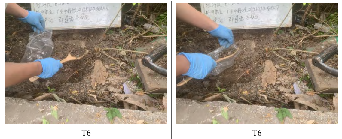
图 5.3-3 土壤重金属样品采样照片
