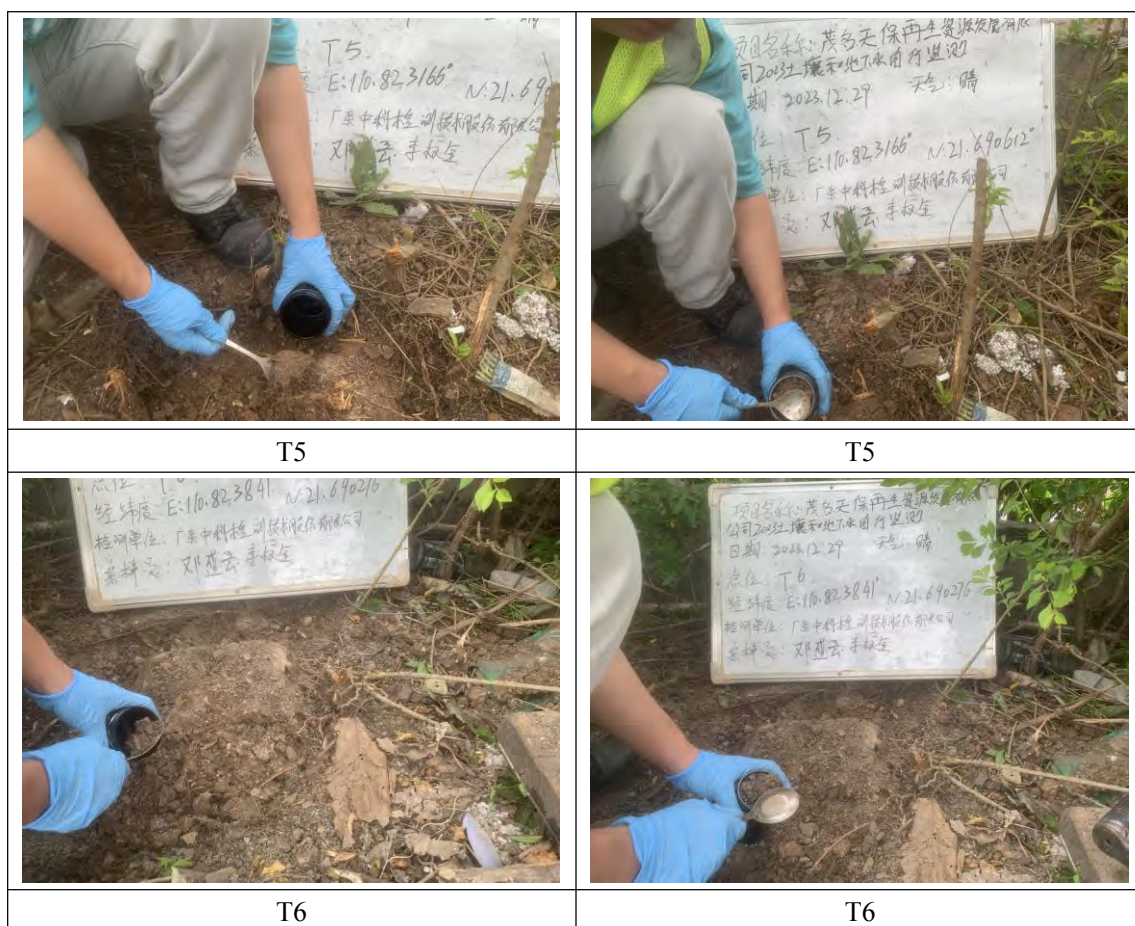
图 5.3-2 土壤半挥发性有机物样品采样照片
