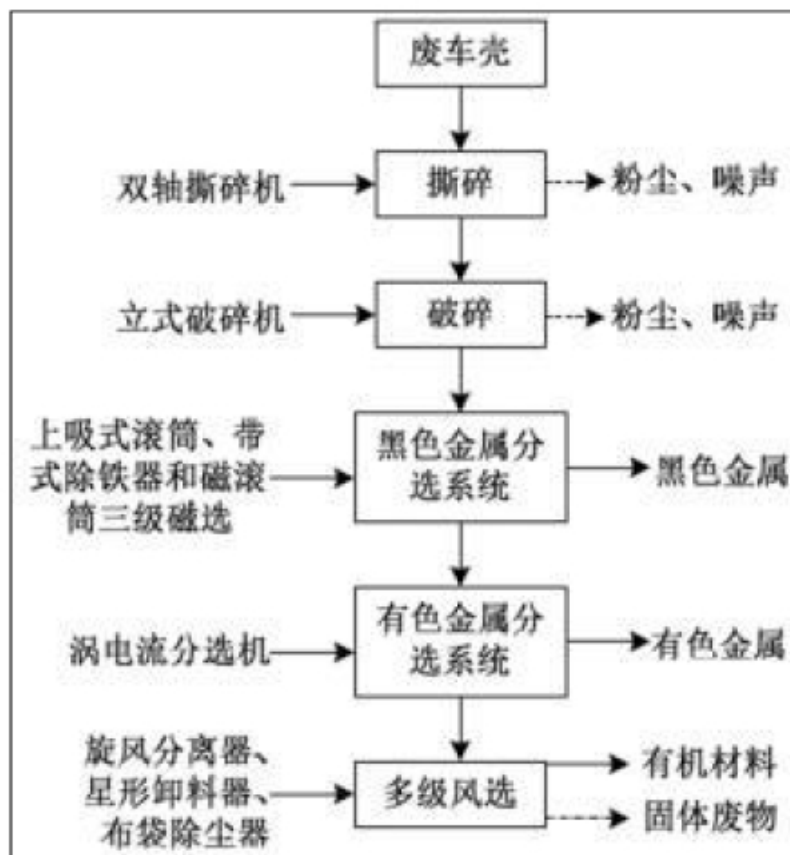
图 3.3-11 破碎工序工艺流程及产污环节图
