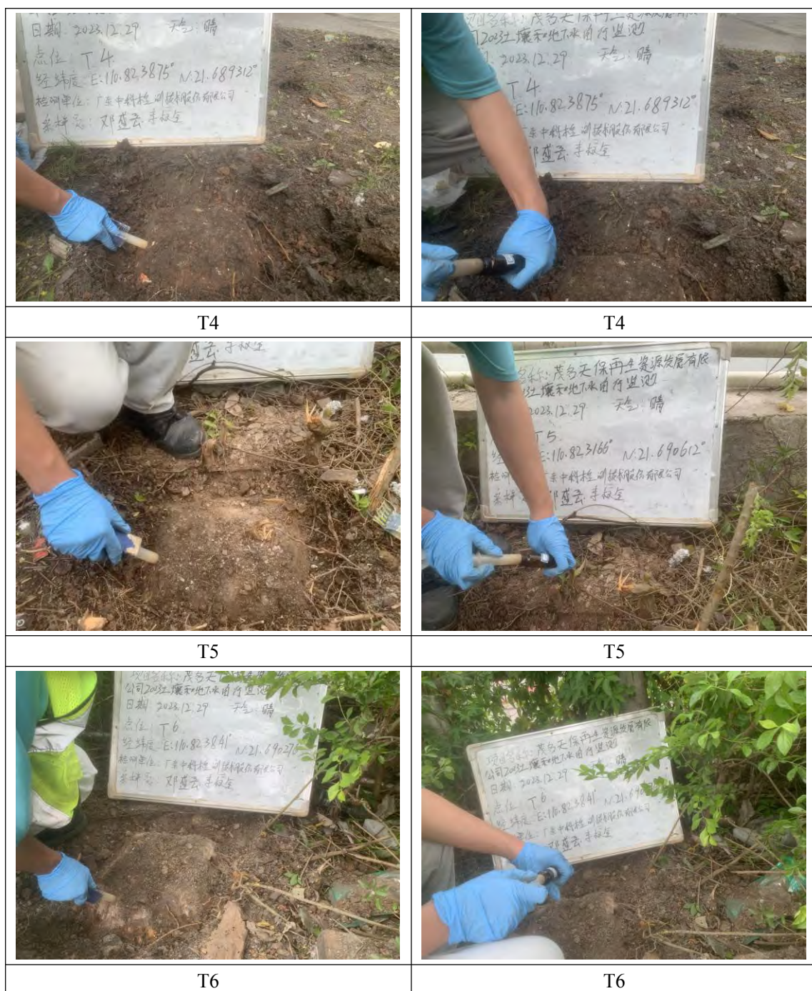
图 5.3-1 土壤挥发性有机物样品采样照片
