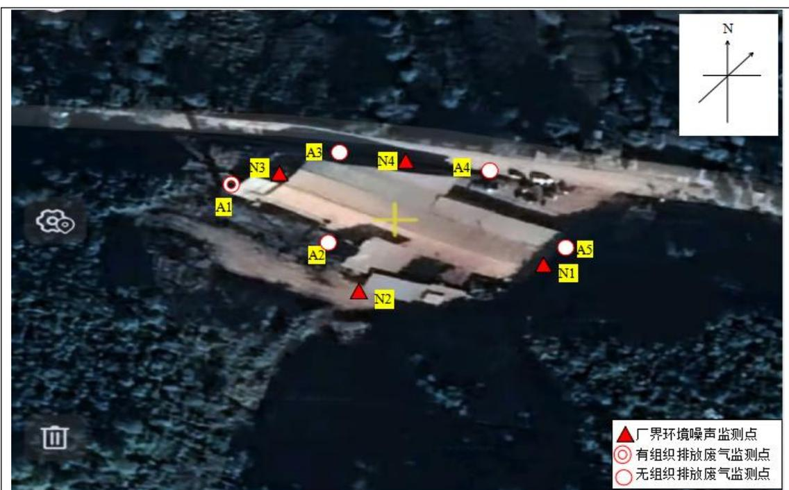
图6-1 废气、噪声监测点位示意图
